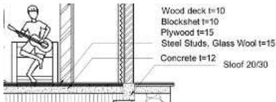
Gambar 5. Sistem Akustik pada Lantai Sumber: Dokumen Pribadi, April 2014
