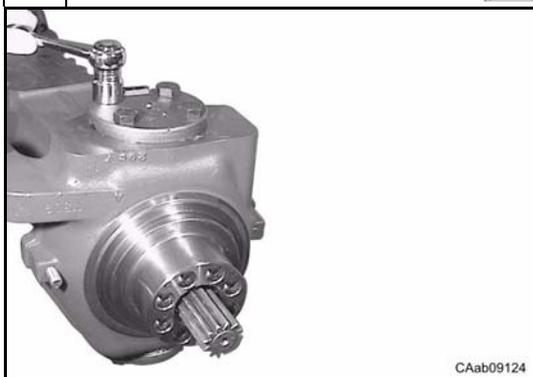
Svitare e togliere le viti di fissaggio (16) e (20) del perno snodo superiore (15) ed inferiore (19).
