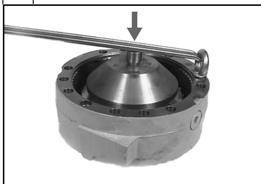
Inserire il pistone (22) nel cilindro freno (14) e posizionare l'attrezzo cod. CA715056 sul pistone.
