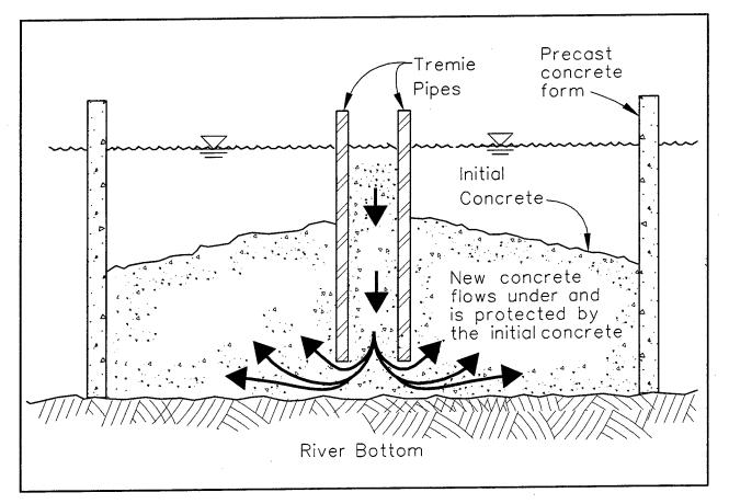
Figure 16. Tremie concrete flow in deep pour
