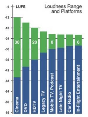
FIG 7. SUGGESTED MAX LOUDNESS RANGE AND TARGET PLATFORMS LRA FOR MOBILE TV SHOULD NOT BE MUCH HIGHER THAN 8 LU
