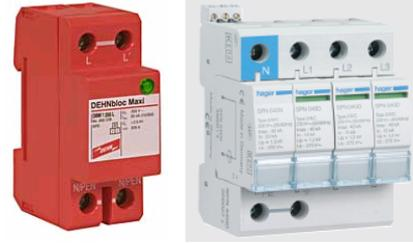
El dispositivo funciona evacuando la corriente de sobretensión a tierra, conectado en paralelo con la instalación que se desea proteger y con un dispositivo de corte en serie con el limitador. La resistencia de la toma de tierra deberá ser lo más baja posible no siendo necesario que sea independiente de la habitual del edificio, en redes de distribución TT. Si se coloca aguas abajo del interruptor diferencial, es recomendable que sea de tipo selectivo para evitar disparos intempestivos.
