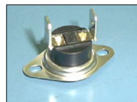
En motores trifásicos se incluye dentro del bobinado y dispone de un contacto auxiliar NC que se debe cablear en serie con la alimentación del circuito de mando. Una vez que se ha producido el disparo, la máquina no podrá volver a arrancar hasta que se haya enfriado.
