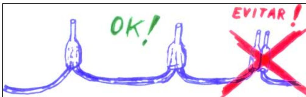
Para los **conductores de protección** está **prohibida la conexión de más de un solo conductor** en una borna, debiéndose de conectar un solo conductor en cada borna y conducir todos los conductores de protección a un único punto común de conexión.
