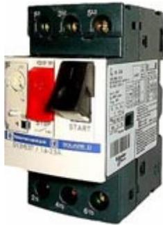
En los dispositivos de protección de instalaciones, tanto el disparo térmico como el electromagnético son regulables en función de las características de la instalación a proteger. En los aparatos destinados a la protección de motores, sólo la protección térmica es regulable para ajustarla a las características del motor.
