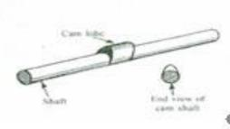
Fig: (d) Cam shaft valve mechanism
