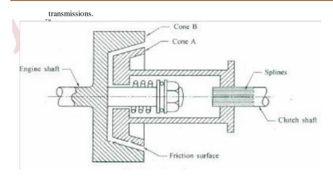
Fig: Cone clutch
