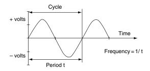
Fig. 17.24 An a.c. waveform
