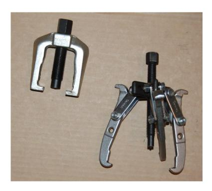
Tie-rod end puller. 3-jaw puller.
