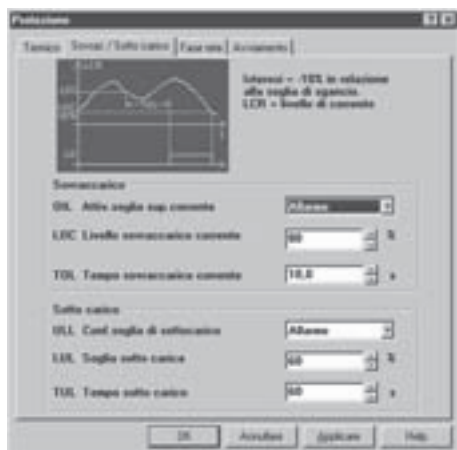
Configurazione sovraccarico e sottocarico dell'avviatore con PowerSuite su PC
