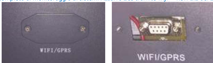
Figura 19 – Alloggiamento della scheda wifi esterna
