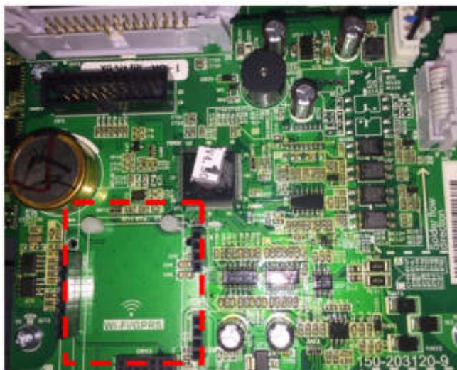
Figura 4 – Posizione di alloggiamento della scheda wifi sulla scheda di comunicazione
