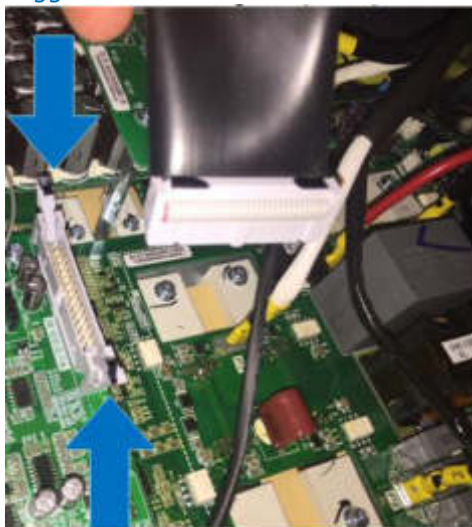
Figura 3 – Apertura dei ganci presenti sull'alloggiamento del connettore flat
