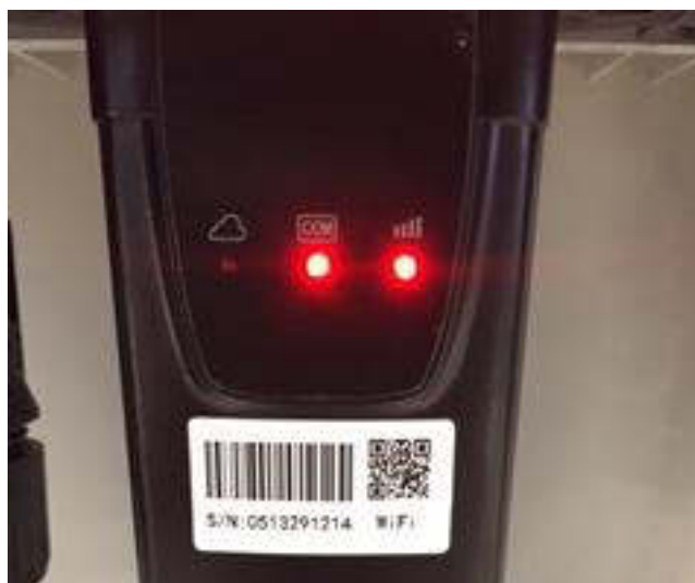
Figura 30 – Stato iniziale dei led
