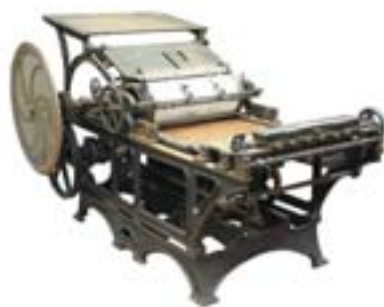
Presse typographique à cylindre, fabriquée par Jullien (Bruxelles, vers 1885-1890) Coll. Casterman AC11 © CHST / IPW
