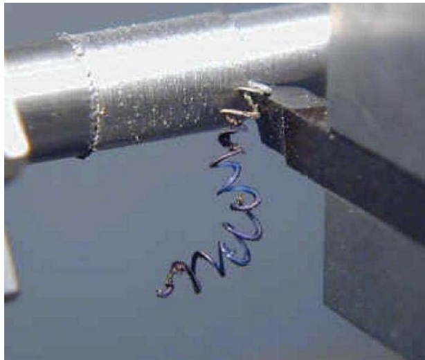
Gambar 3. Pembentukan geram pada proses bubut
