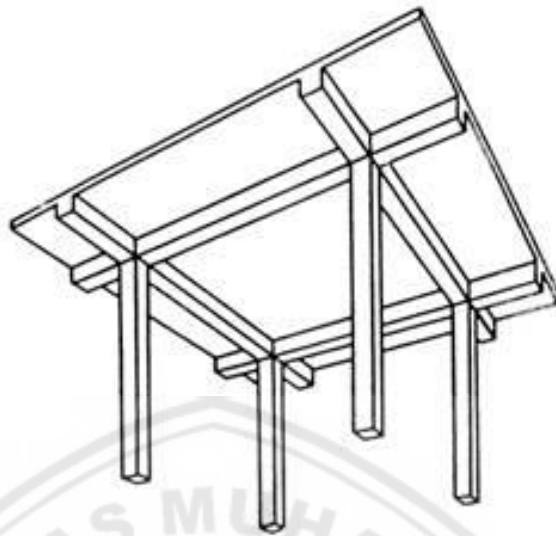
Gambar 2.4 Sistem Plat balok menerus satu arah
