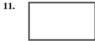
**On-line computer process.** Simbol ini menggambarkan pengolahan data dengan komputer secara on-line. Nama program ditulis di dalam simbol.
