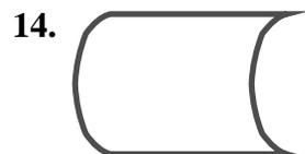
**On-line storage.** Simbol ini menggambarkan arsip komputer yang berbentuk on-line (di dalam memory komputer).
