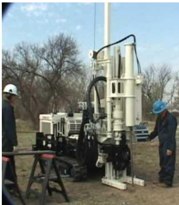
Gambar Mesin SPT dan SPT manual
