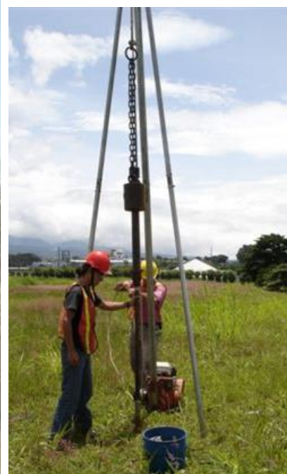
Gambar Mesin SPT dan SPT manual
