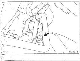
(d) Remove the nut and separate the tube clamp.
