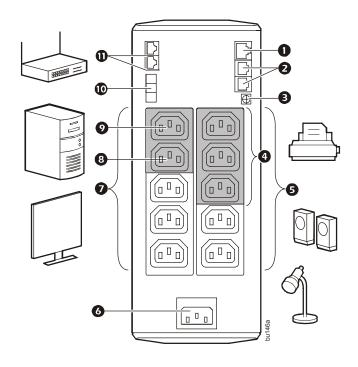
Schließen Sie ein Master-Gerät, wie z. B. einen Desktop-Computer oder ein audiovisuelles Empfangsgerät, an den Master-Ausgang an. Schließen Sie Peripheriegeräte, wie z. B. Drucker, Lautsprecher oder Scanner, an die Slave-Ausgänge an.
