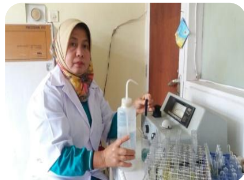
h. Pengukuran C-organik dan P dengan Spektrofotometer
