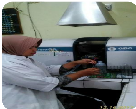
g. Pengukuran K, Na, Ca, Mg, Cu, Mn, Zn dan Fe dengan AAS
