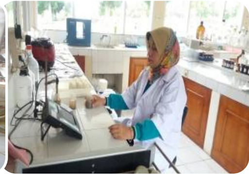
d. Pengujian pH dan Daya Hantar Listrik dengan konduktiviti meter
