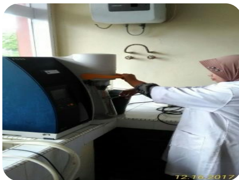
e. Pengujian KTK dan N dengan Kjeltec dan Buret
