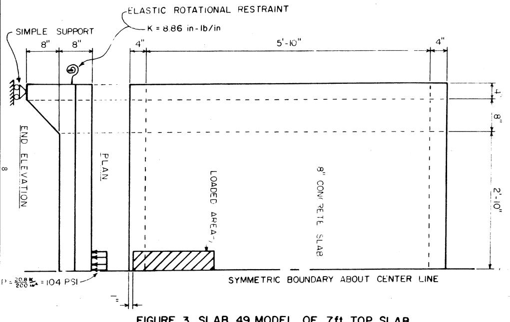
FIGURE 3. SLAB 49 MODEL OF 7ft TOP SLAB
