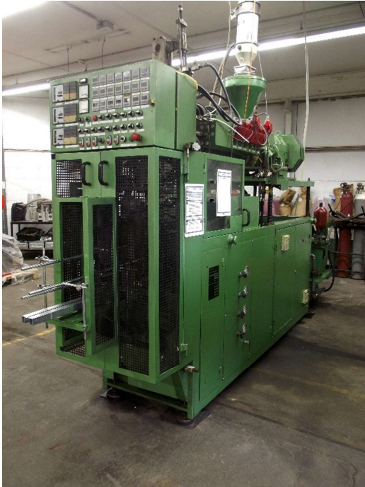
KEB 2 = Kautex- Einschieß- Blasformmaschine bis 2 ltr. Artikelvolumen, mit kontinuierlicher Extrusion
