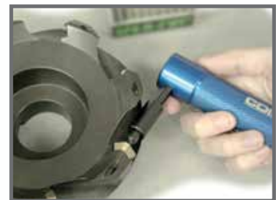
Réduit l'usure prématurée des empiècements en carbure et évite les dommages à la tête de coupe causés par une force de serrage inappropriée.
