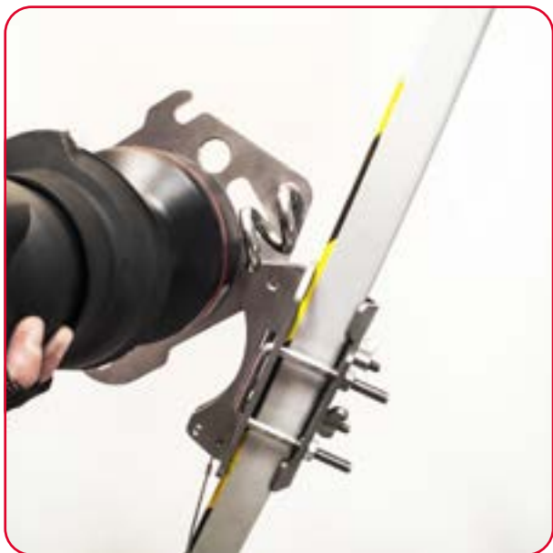
4. Plasser vinsjen og platen på tripodadapteren.
