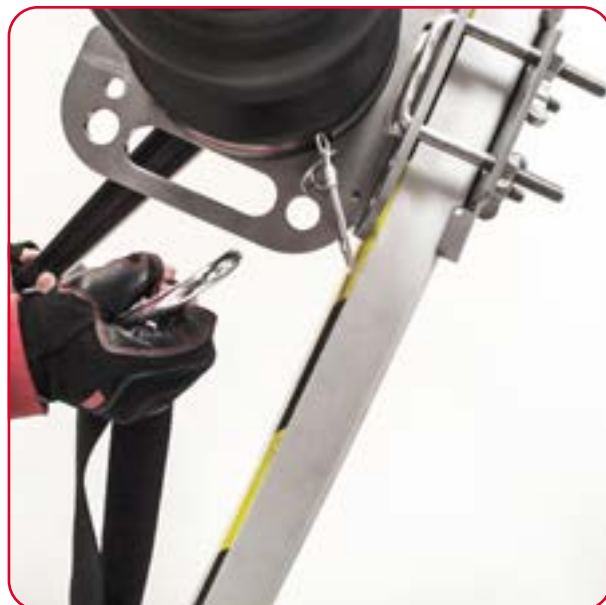
7. Koble kontakten og foranringsanordningen til platen på vinsjsiden, og til et sikkert forankringspunkt på motsatt side.
