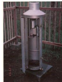
Gambar 3.4. Pengukur hujan manual.(kiri) Pengukur hujan otomatis (kanan)
