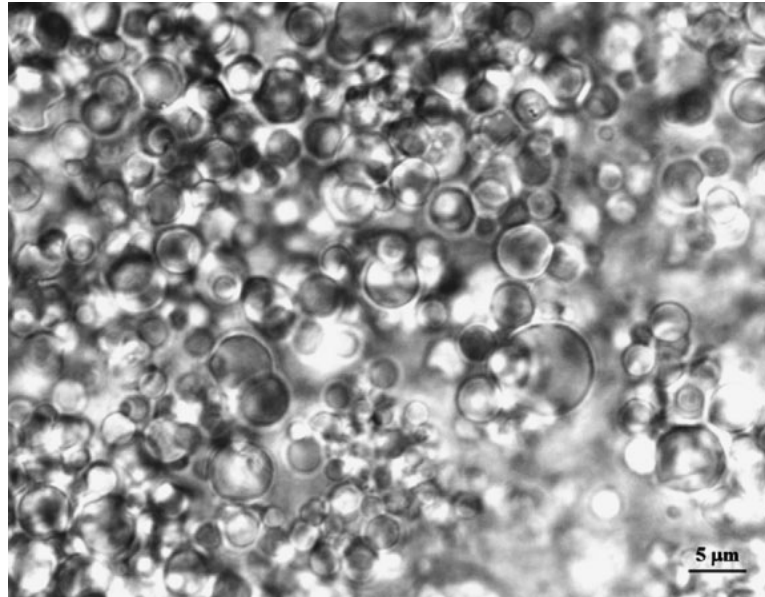
Gambar 23. Mikrokapsul dengan inti cairan dan lapisan silicon dipersiapkan menggunakan teknik in situ polymerization
