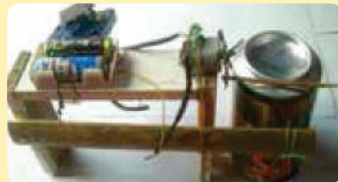
Sumber: Dok. Kemdikbud Gambar 2.31. hasil akhir bel sederhana dengan arus listrik DC
