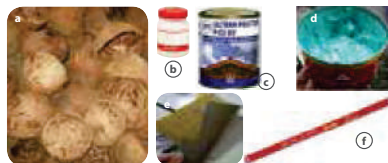
Sumber: Dok. Kemdikbud Gambar 1.32. Bahan dan alat pembuatan kerajinan tempurung kelapa: a) Tempurung kelapa, b) Lem, c) Poltuir, d) Dempul, e) Amplas, f) Gergaji besi.
