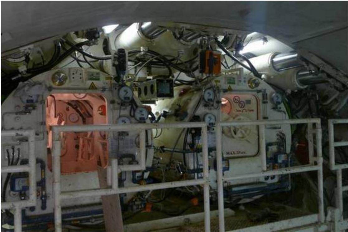
Figure 2 : Vue des deux sas d'accès hyperbares au sein du bouclier permettant l'entrée et la sortie des salariés qui ont accès à la chambre d'abattage.
