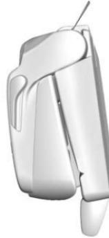
3. Levante la palanca de nuevo para liberar la parte trasera del asiento del piso. El asiento se abatirá hacia delante.
