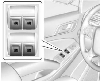
Las ventanas eléctricas funcionan cuando la ignición está encendida, en ACC/ACCESSORY (Accesorios), o cuando la Energía retenida para los accesorios (RAP) está activa. Consulte *Energía retenida para los accesorios (RAP)* ⇨ 259.
