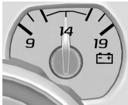
Cuando la ignición está encendida, este medidor indica el voltaje de la batería.
