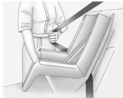
4. Jale el cinturón de hombro completamente fuera del retractor para ajustar el seguro. Cuando el seguro del retractor
