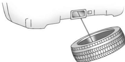
7. Incline la llanta hacia el vehículo dejando algo flojo el cable, para tener acceso al retenedor de la llanta/rueda. Inclíne el dispositivo de retención y jálalo así como el cable y el resorte a través del centro de la rueda.
