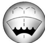
Abra el tapón que tiene el símbolo del lavaparabrisas. Agregue líquido para lavaparabrisas hasta llenar el tanque. Vea en *Vista general del compartimiento del motor* ⇨ 338 la ubicación del depósito.
