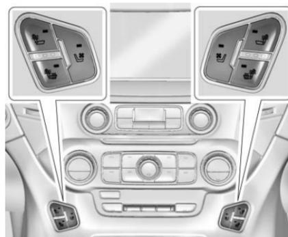
Los botones están en la columna central debajo del sistema de control del clima. Para que funcione, el motor debe estar encendido.
