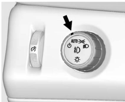
El control de luz exterior está en el tablero de instrumentos, a la izquierda del volante de la dirección.
