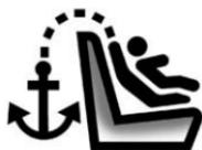
Para ayudar a ubicar los anclajes de correa superior, el símbolo del anclaje de correa superior está cerca de los anclajes de la correa superior para asientos de la segunda fila. En los asientos de la tercera fila (si está equipado), el símbolo de anclaje de sujeción superior se encuentra en el panel de la aleta.
