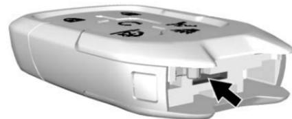
1. Con la llave removida, inserte un objeto delgado y plano en el centro del transmisor para separar y retirar la cubierta posterior.
