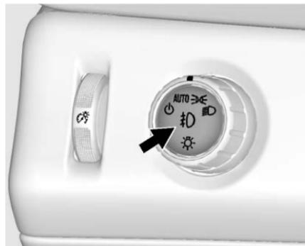
Si está equipado con luces anti-niebla, el botón se encuentra en el control de luces exteriores, a la izquierda de la columna de la dirección.
