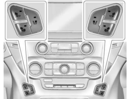
Los botones se encuentran en la columna central debajo del sistema de control climático. Para que funcione, el motor debe estar encendido.
