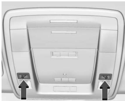
Hay luces de lectura en la consola elevada y el recubrimiento, si están equipadas. Para operar, la ignición debe estar activada o en ACC/ACCESORIOS, o utilizando Energía retenida para los accesorios (RAP).
