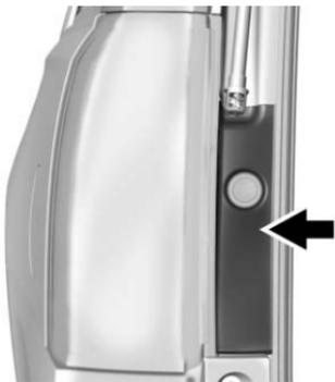
2. Retire la tapa de cierre de la luz trasera del conjunto del faro jalando hacia atrás desde la parte superior e inferior al mismo tiempo para desenganchar las lengüetas de presión.
