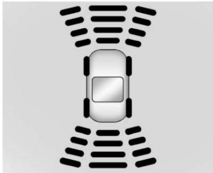
El cuadro de instrumentos puede tener una pantalla de asistente de estacionamiento con barras que muestren "distancia hasta el objeto" y la información de la ubicación del
