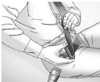
Para posiciones de sentado delantero, si el tejido se bloquea en la placa del cerrojo antes de que alcance la hebilla, incline la placa de cerrojo para que quede plana para desbloquear.
