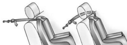
Si la posición que usa tiene un reposacabezas o cabecera fijos y está utilizando una correa sencilla, guía la correa alrededor del lado interno o del lado de la ventanilla del reposacabezas o cabecera.
