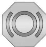
El depósito del cilindro maestro de frenos se llena con líquido de frenos DOT 3 aprobado por GM, como se indica en el tapón del depósito. Vea en *Vista general del compartimiento del motor* ⇨ 338 la ubicación del depósito.
