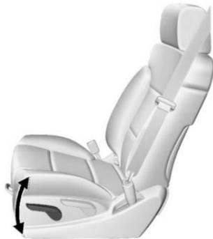
Si está equipado, mueva la palanca hacia arriba o hacia abajo en forma repetida para aumentar o reducir el soporte lumbar.
