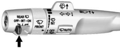
El control del limpiaparabrisas trasero está en la palanca direccional.
