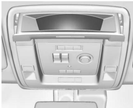
Si está equipado, el espejo de visión infantil está en la consola superior. Presione el botón fijo en la cubierta para soltarlo. Presione hacia arriba el espejo cuando no esté en uso.
