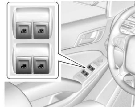
Las ventanas eléctricas trabajan cuando la ignición está encendida, en ACC/ACCESSORY (Accesorios), o cuando Energía retenida para los
