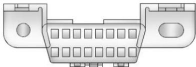
El DLC está debajo del tablero de instrumentos del lado izquierdo del volante. Conectar dispositivos que no se utilicen para realizar una Inspección de emisiones/Prueba de mantenimiento o para dar servicio al vehículo puede afectar la operación del vehículo. Vea *Equipo eléctrico añadido* ⇨ 332. Visite a su distribuidor si necesita asistencia.
