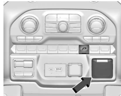
En el tomacorriente de cabina e interruptor CD/CA
