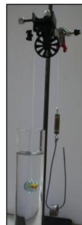
Figura 6: Imagen de un montaje realizado para estudiar la caída de un cuerpo en un medio viscoso.
