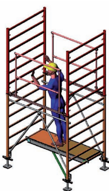
7 Mise en place des cadres et verrouillage des broches
