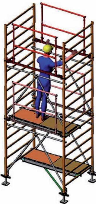
10 Mise en place des lisses connecteurs GC et des cadres, puis verrouillage des broches
