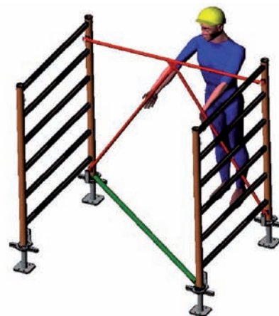
3 Mise en place de la diagonale et verrouillage des vérins imperdables
