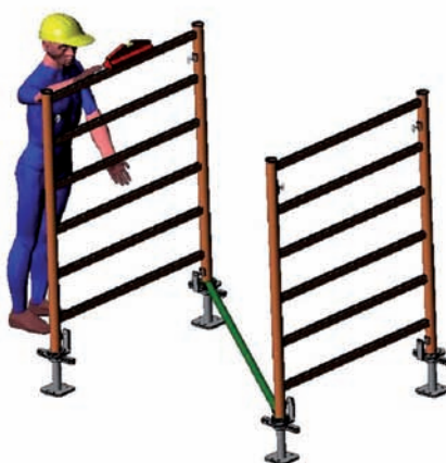
2 Mise en place des cadres
