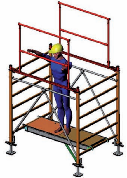
6 Mise en place des lisses connecteurs GC
