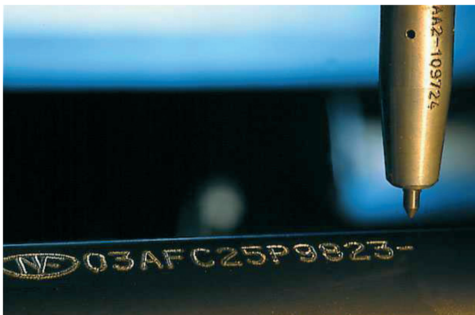
Marquage d'un élément de tour normalisé
