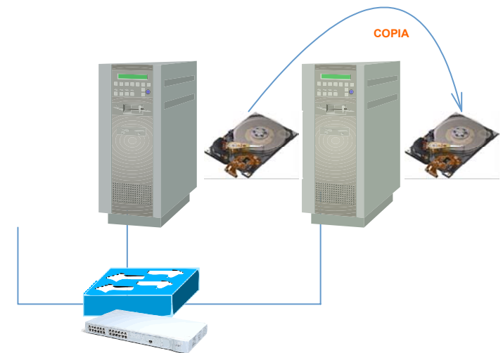
Ilustración 14: Replicación: una partición de NDS puede estar replicada en varios servidores.
