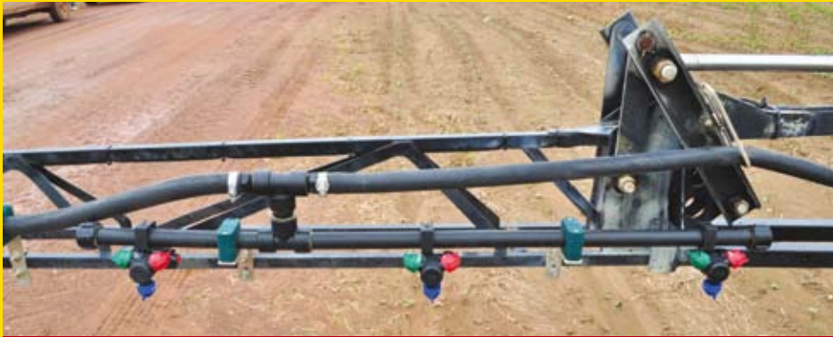
Detalhe de uma das cinco sessões de barra que equipam o pulverizador na versão standard. Como opcional, é possível dividir a barra em sete sessões, uma central e três para cada lado
