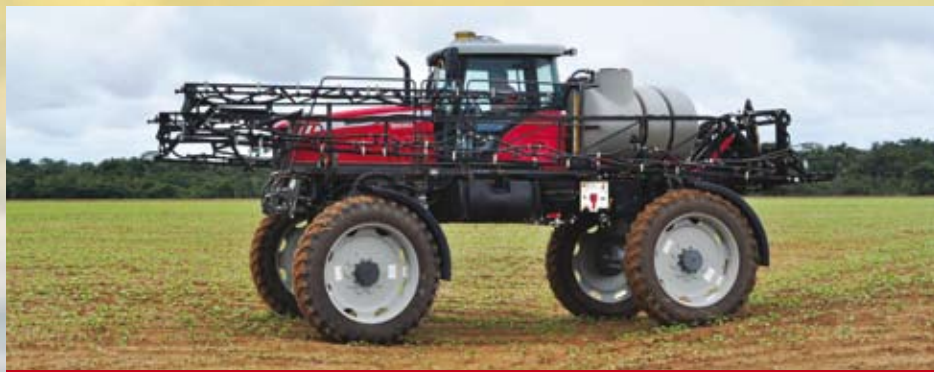
O MF 9030 tem motor AGCO Sisu Power 620DS, de 6 cilindros, com potência de 200 cv, é o mesmo motor utilizado nas colhedoras MF 32
