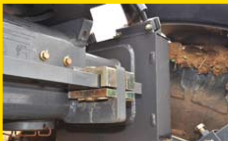
O ajuste da bitola é automático, bastando remover um pino "R" para realizar a operação
