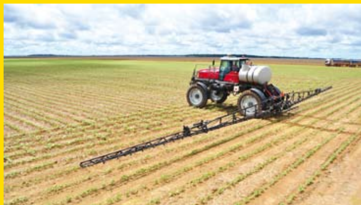
A barra porta bicos varia de 24 a 28 metros sendo recomendada a de 24 metros para cana de açúcar, com um rodado maior e a 28 metros para a versão grão. A altura da barra em relação ao solo pode variar desde 0,55 a 1,95 metros
