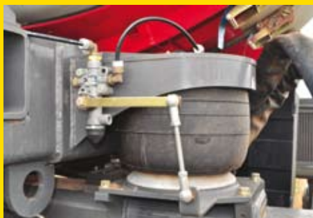
A suspensão é pneumática ativa, onde os eixos dianteiros e traseiros são ligados ao chassi por câmaras de ar
