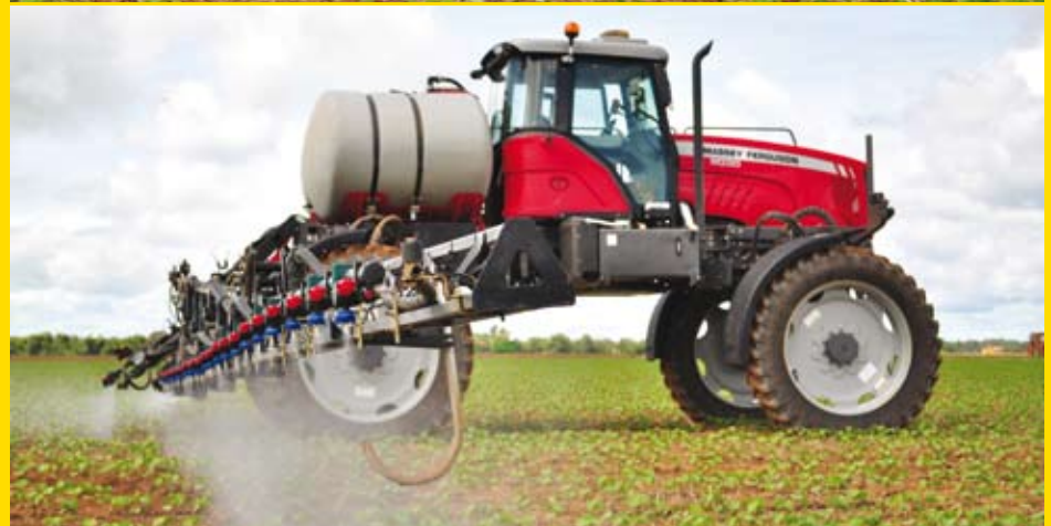
Com a transmissão equipada é possível realizar aplicações a até 30 km/h, velocidade utilizada durante o teste, onde o equipamento manteve bravamente a estabilidade das barras
