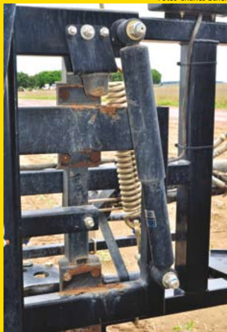
Amortecedor e mola responsáveis pela estabilização das barras de pulverização vertical e horizontalmente
