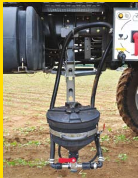
Detalhe do lava-frascos e incorporador de produtos, que pode descer ao nível do operador, facilitando a operação
