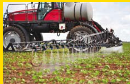
O pulverizador possui um sistema de desarme automático das barras, caso colisão com algum objeto
