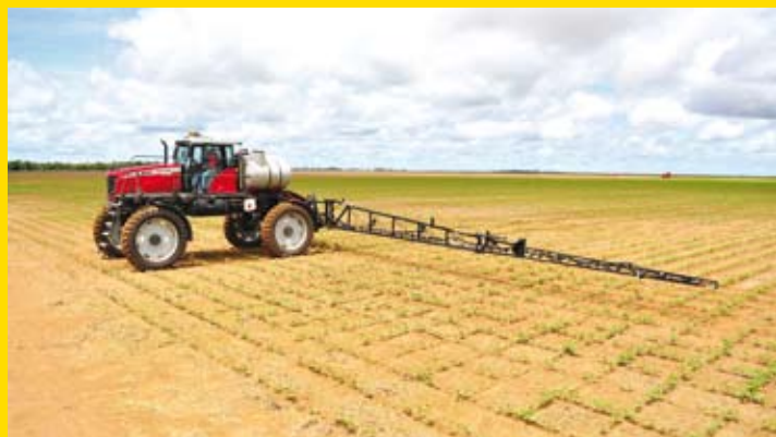
A barra porta bicos varia de 24 a 28 metros sendo recomendada a de 24 metros para cana de açúcar, com um rodado maior e a 28 metros para a versão grão. A altura da barra em relação ao solo pode variar desde 0,55 a 1,95 metros
