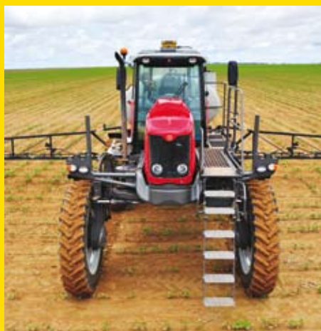
A escada de acesso à cabine recolhe automaticamente cada vez que o freio de mão é liberado
