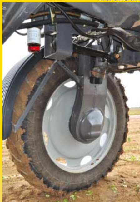
A transmissão hidrostática utiliza duas bombas hidráulicas e motores individuais de roda, da marca Bosch
