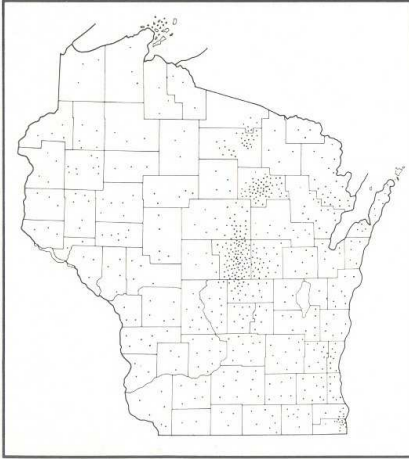
Mapa de puntos en que el valor de unidad asignado a un punto es demasiado grande. Pueden incluirse pocos puntos lo que produce un mapa muy árido que revela poca configuración. Cada punto en este ejemplo representa 60,7 hectáreas.
