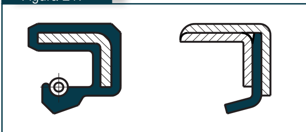
Modelo BAUX2 (izda) vs modelo B2PT (dcha) para una presión de hasta 10 bar.
