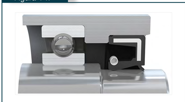
Estanqueidad dinámica radial INTERNA. Retén con guardapolvo.
