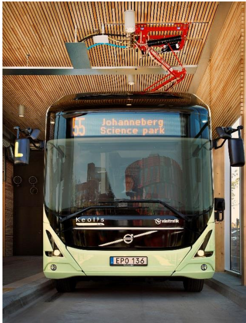
Figura 2-12 Autobús eléctrico de batería con unidad de carga rápida montada en la parte superior (Fuente: Volvo y Siemens)
