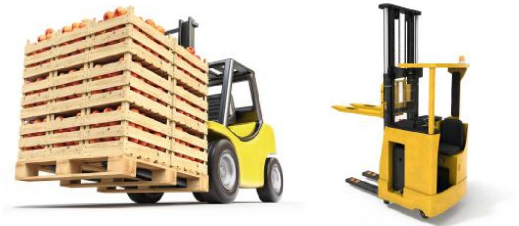
Figura 7 Carrello elevatore motorizzato su pneumatico.
