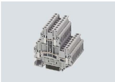
Il morsetti doppio ponte 8WH è disponibile nelle sezioni nominali di 2,5 e 4 mm<sup>2</sup>. Con uno spessore di 5,2 o di 6,2 mm, lo spazio all'interno del quadro elettrico si riduce del 50%. Su ogni livello del doppio ponte è possibile con facilità e sui diversi livelli inserire targhette di riconoscimento per tutti i punti di connessione.
