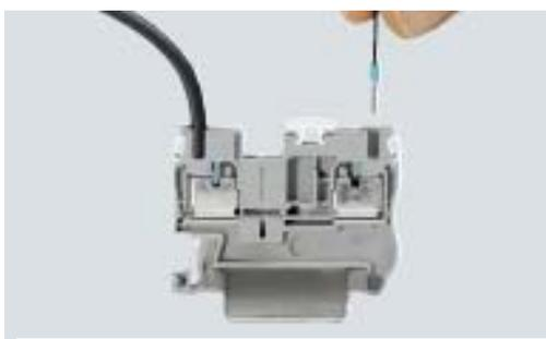
Spina super leggera: utilizzando una forza inferiore al 50% il metodo di connessione semplice e diretto permette l'inserimento di un conduttore rigido o flessibile con terminale con una sezione maggiore di 0,34 mm<sup>2</sup>
