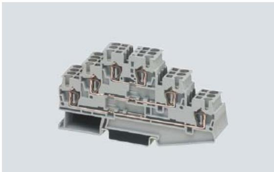
I morsetti tripli hanno tre piani passanti in solo 5,2 mm di spessore. Questo permette di poter utilizzare in poco spazio una serie notevole di cablaggi.
