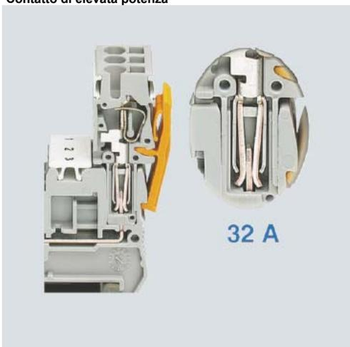
Il perfezionato sistema Combi consente di realizzare un cablaggio estraibile fino ad una corrente nominale di 32 A e una tensione nominale di 800 V. Grazie alla molla integrata il sistema di contatto è quindi in grado di resistere a requisiti estremi per quanto riguarda le vibrazioni.
