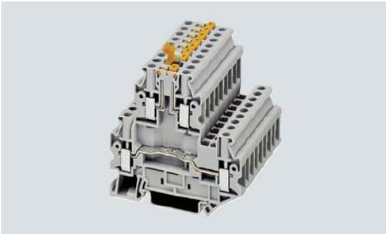
I morsetti doppi 8WH1, sono utilizzabili con i morsetti doppi sezionatori a coltello. Nel cablaggio segnale sono sempre nello stesso spazio più punti di contatto/punti di contatto a filo. Utilizzando morsetti doppi, si riduce del 50% lo spazio della morsettiera all'interno del quadro elettrico.
