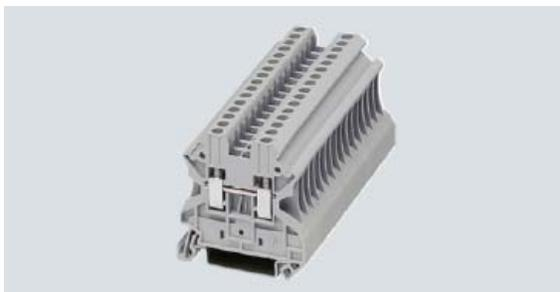
I morsetti passanti 8WH sono caratterizzati da una costruzione compatta e ottima maneggevolezza. Essi sono disponibili per conduttori con sezione da 2,5 a 35 mm<sup>2</sup> e possono essere etichettati. Il doppio ponte consente la connessione singola per mezzo di pettini di collegamento. Accessori corrispondenti sono disponibili per test e etichettature. Con la guida di sostegno, sono assicurati contatti meccanici ed elettrici sicuri semplicemente bloccando i morsetti sulla guida.
