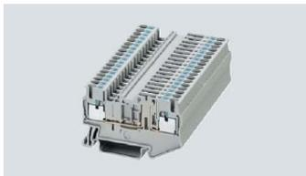
I morsetti sezionabili 8WH6 con tecnologia di connessione iPo sono utilizzabili per speciali commutazioni. Con lo stesso profilo dei morsetti con sezionatore a coltello, i morsetti sezionabili 8WH6 sono equipaggiati con una spina universale nel centro dello stesso. Numerose commutazioni possono essere inserite sui morsetti spesso solo di 5,2mm predisposti per connettori passanti, spine di sezionamento, spine portafusibili.
