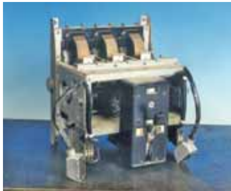
Figura 1 e Figura 2 – L'attività di rigenerazione condotta su un interruttore ABB SACE OTOMAX presso le officine del costruttore. A destra l'interruttore dopo l'intervento.
