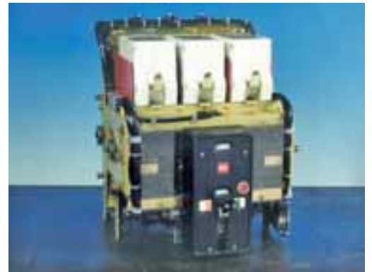
Figura 1 e Figura 2 – L'attività di rigenerazione condotta su un interruttore ABB SACE OTOMAX presso le officine del costruttore. A destra l'interruttore dopo l'intervento.
