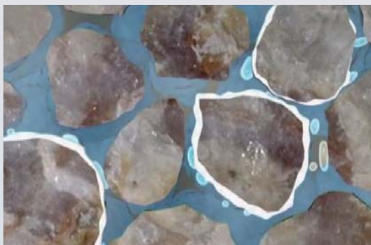
Slika 2 Gusti CO 2 migrira prema gore (svijetloplavi mjehurići), otapa se i reagira sa zrnima stijene dovodeći do taloženja karbonatnih minerala na granicama zrna (bijelo).
