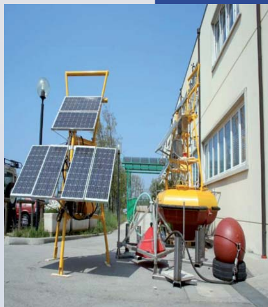
Slika 2 Plutača za praćenje sa solarnim pločama za opskrbu energijom, plovcu i naprava koja skuplja uzorke plina s morskog dna.
