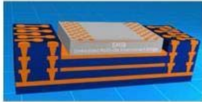
2) EMIB Die embedding into cavity
