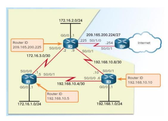
R1(config)# router eigrp 1 R1(config-router)# eigrp router-id 1.1.1.1 R1(config-router)#
