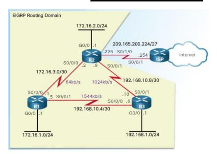
R1(config) # interface s 0/0/0 R1(config-if) # bandwidth 64 R3(config)# interface s 0/0/1 R3(config-if)# bandwidth 1024
