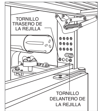
Tornillos de montaje de la rejilla
