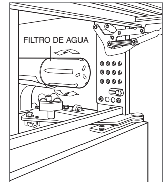
Extracción del filtro de agua
