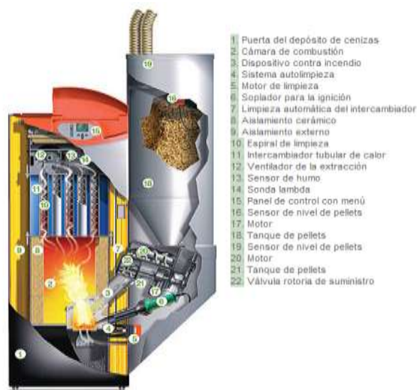
Figura 26: caldera de pellets con depósito instalado.
