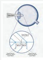
LIGHTLas YAG-V ±500 µm Posterior/ Anterior Offset
