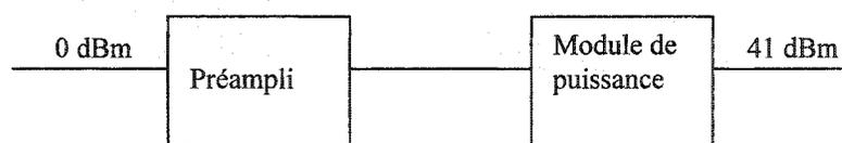
Figure 12 Cascade des amplificateurs de 41 dBm
