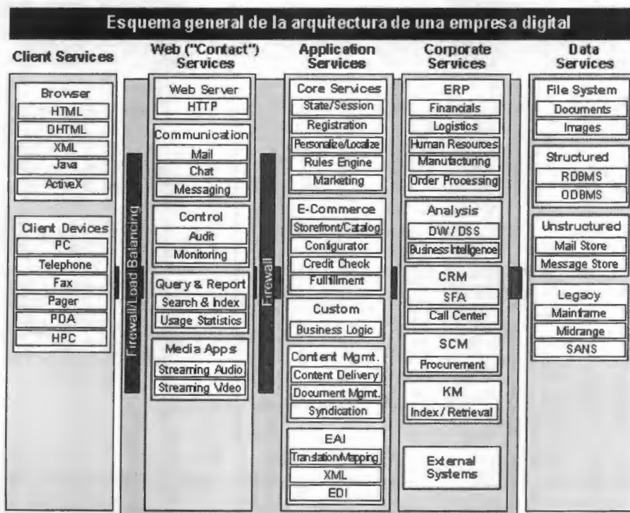
Figura 2.4 Esquema detallado de una arquitectura Web
