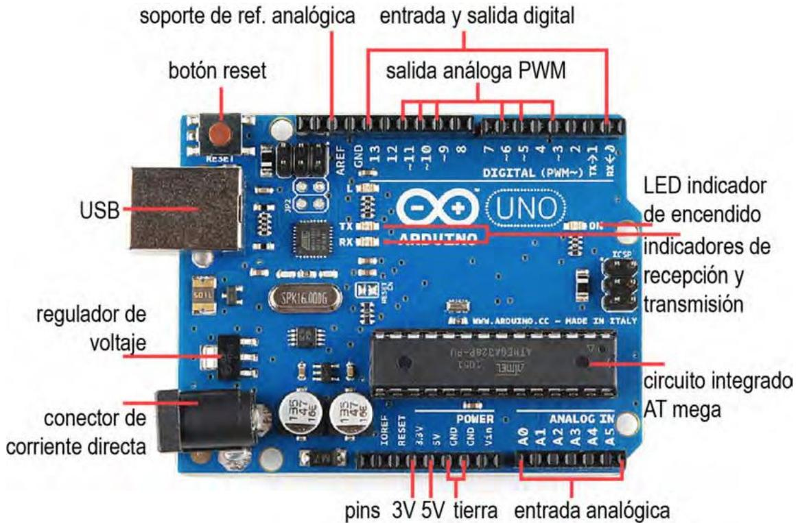
Las características relacionadas con el funcionamiento de cada uno de los modelos de placa Arduino son diferentes dependiendo de los distintos procesadores y componentes, en el caso de la placa Arduino UNO, estos serían los requerimientos para lograr una óptima función:
