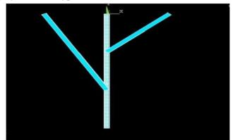
Solution ► Define Loads ► Apply ► Structural ► Displacement ► On key Points ► Select keypoints 2 & 3► select UX,UY,UZ,ROTX,ROTY►Ok
