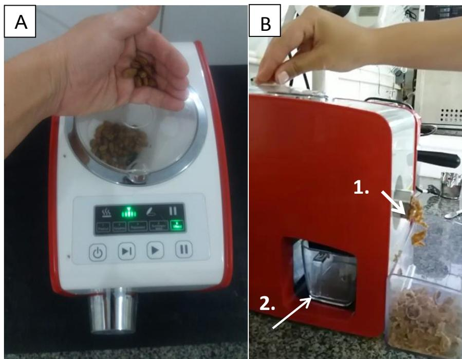
**Figura 6.** Processo de extração dos grãos de graviola: A – inserção dos grãos de graviola na extratora; B.1 – Saída da torta na parte frontal da máquina e B.2 - óleo extraído dentro do reservatório.
