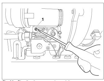
Fig. 33 Bleeding the gas supply conduit
