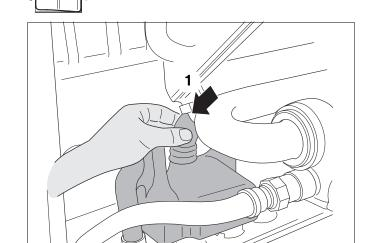
Fig. 48 Condensate trap
