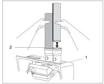
Fig. 15 Vent pipes
